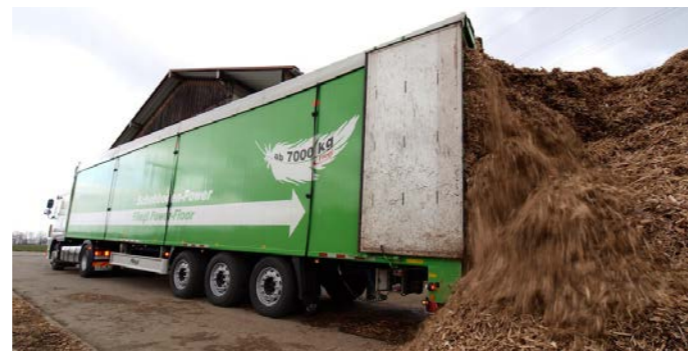
600 mm Muldenwandprofile machen den Trailer extrem robust. Fliegl bietet 6, 8 und 10 Millimeter starke Aluminium-Schubbodenprofile an sowie Heavy Duty und Stahlbodenvarianten.
